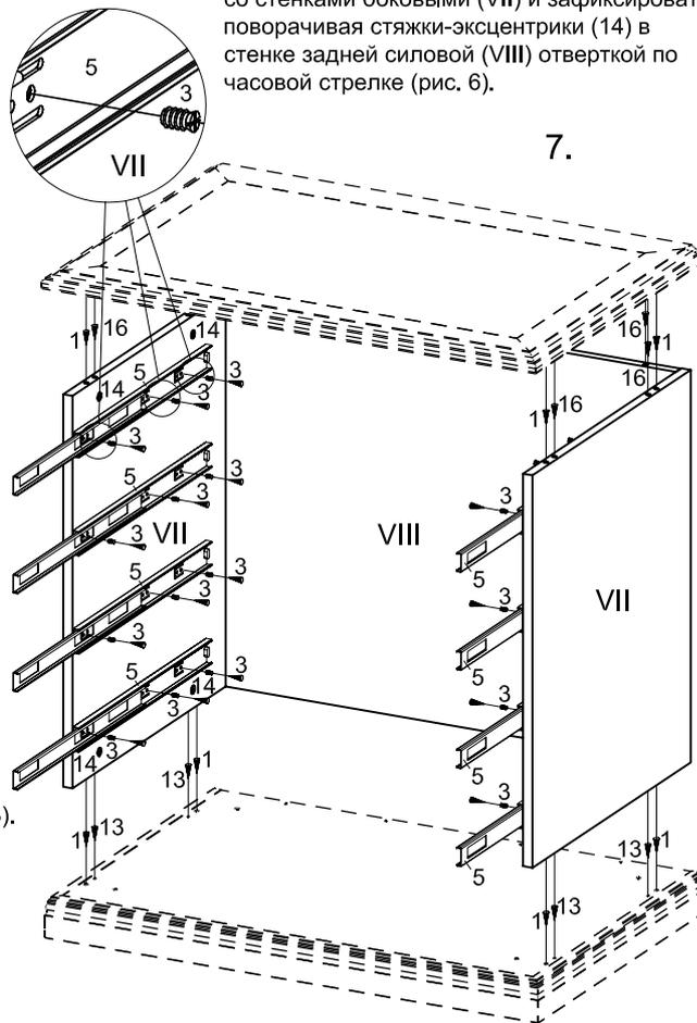
Закрыть стяжки-эксцентрики в корпусе комода заглушками (17).
