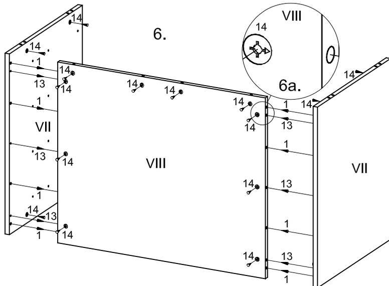
**Сборка корпуса комода:** Положить стенки боковые (VII) и стенку заднюю силовую (VIII) на чистую ровную поверхность глухими отверстиями Ø15мм вверх. В отверстия Ø15мм вставить стяжки-эксцентрики (14) стрелкой в направлении отверстий на торцах (рис. 6 и 6а). В глухие отверстия Ø5мм в стенках боковых (VII) вкрутить дюбеля (13) стяжек-эксцентриков до упора в обод, а в глухие отверстия Ø8мм вбить шкранты (1).
