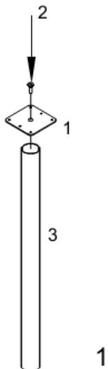
Положить столешницу, установить опору в требуемом месте (по оси симметрии столешницы) фланцем крепления вниз и закрепить 6-ю саморезами (4) (см. рис.2).
