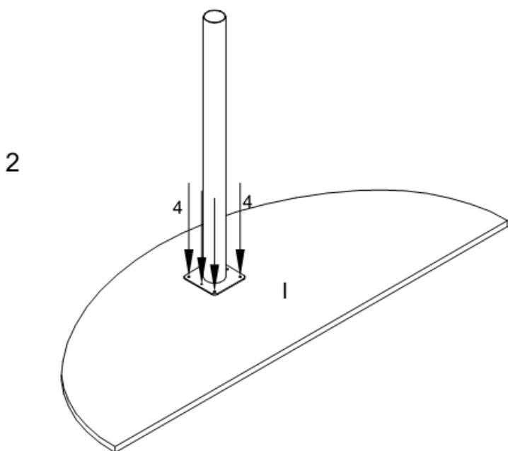
Для крепления конференц-приставки к столу или столам, в зависимости от артикула изделия, использовать пластины крепежные (6) и саморезы (5) предварительно отрегулировав высоту приставки при помощи регулируемой нижней части ноги.
