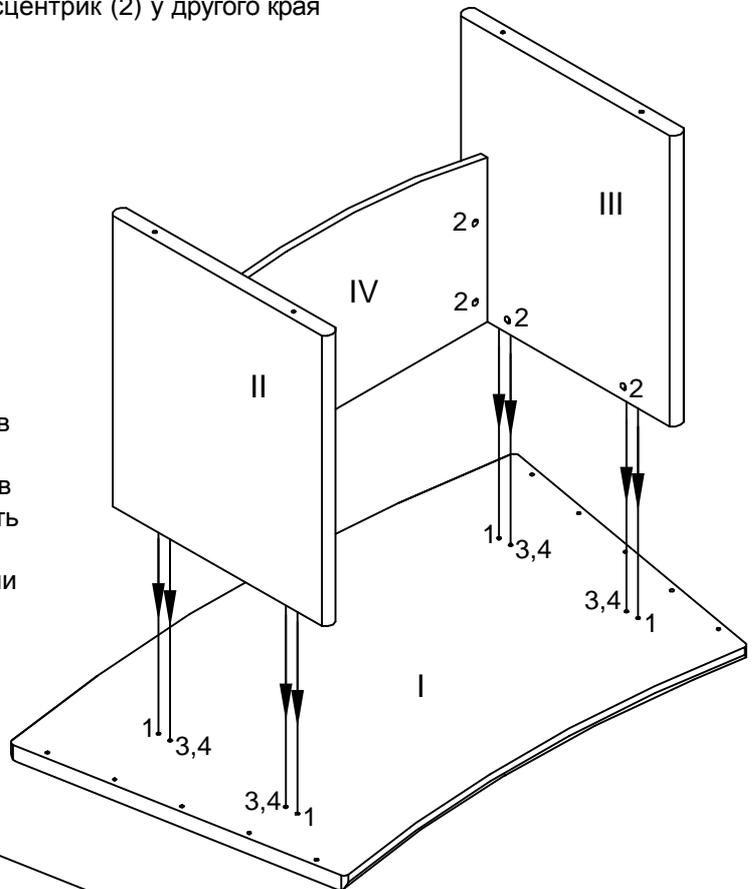
Положить столешницу отверстиями вверх. Забить в столешницу шканты (1) и цанговые футорки (4). Вкрутить в цанговые футорки дюбеля (3) до упора в обод. Присоединить к столешнице каркас и затянуть отверткой стяжки-эксцентрики (2) на боковинах. Закрыть торцы стяжек-эксцентриков декоративными заглушками. Поставить стол.
